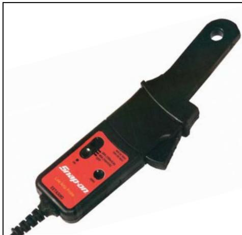
Figure 9-6 Sonde de courant basse intensité
