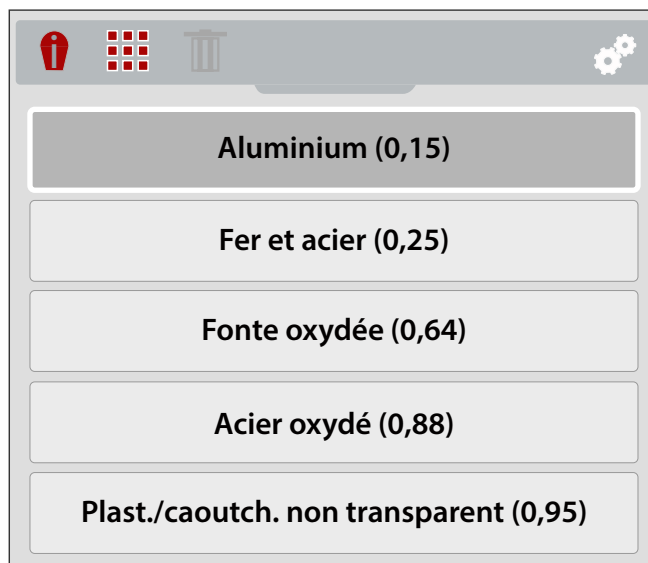
Figure 3-25 Menu de paramètres d'émissivité
