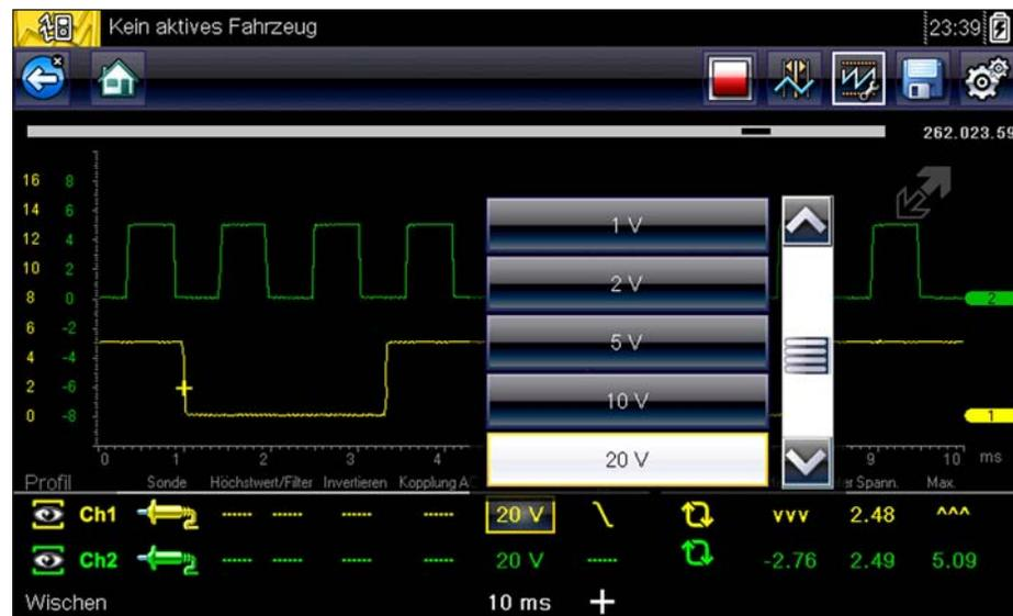
Abbildung 8-9 Beispielmönü für die Skalierung
