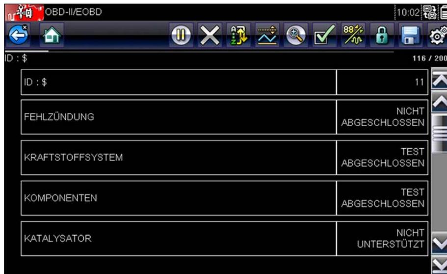
Abbildung 6-3 Beispielprüfbericht der Bereitschaftsüberwachung
