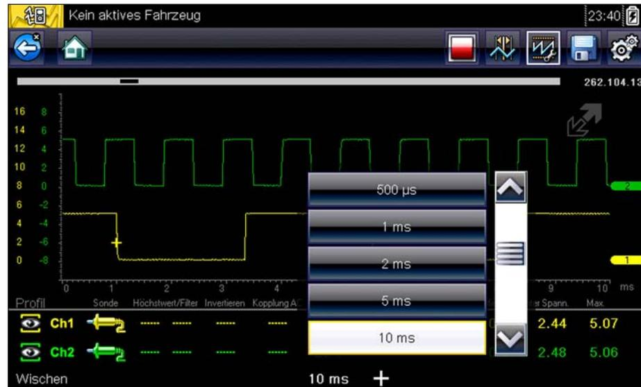
Abbildung 8-11 Beispielmenü für die Ablenkung
