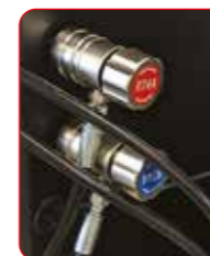
Acoplamiento rápido SAE J639 Función híbrida
