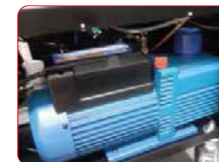
Potente bomba de vacío de dos etapas 142 l/min
