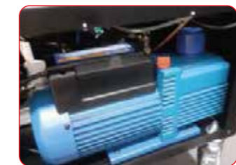
Pompe à vide puissante à deux étages 142 l/min
