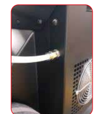
Raccord rapide pour tuyau d'évacuation CO 2
