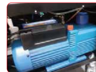
Starke Vakuumpumpe 142 l/min zweistufig
