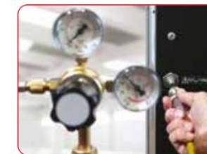
Control de presión de nitrógeno
