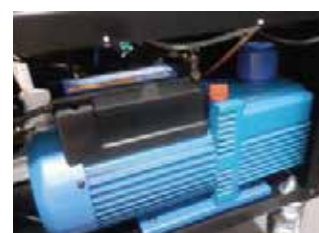
Starke Vakuumpumpe 142 l/min zweistufig
