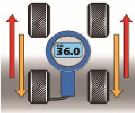
Lleve a cabo el procedimiento de liberación del sistema TPM después de realizar algún servicio en los neumáticos o después de ajustar la presión. Nota: el ajuste de presión en frío siempre se recomienda cuando se ajustan las presiones al valor especificado.
