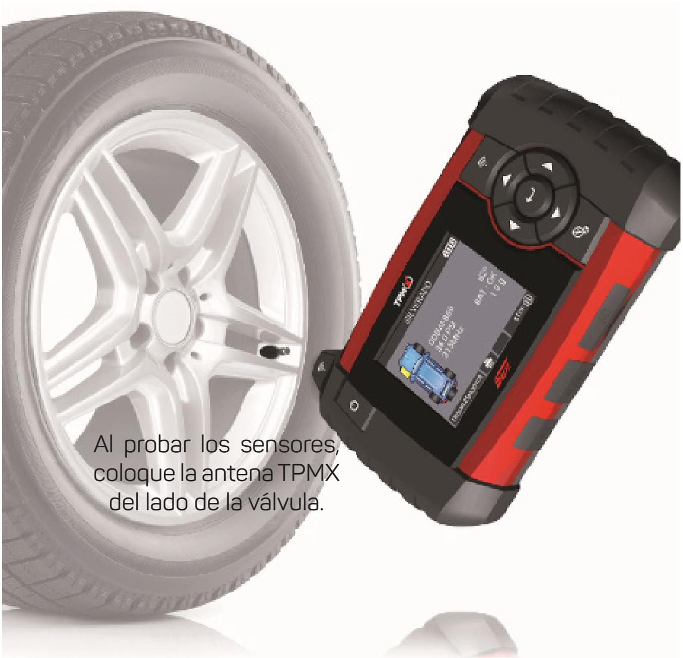
Al probar los sensores, coloque la antena TPMX del lado de la válvula.
