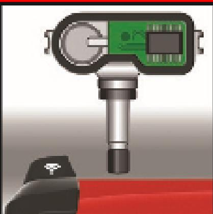
Reemplace el sensor del vehículo con un sensor original. Siga las instrucciones en pantalla y vuelva a aprender el sistema TPM después de reemplazar todos los sensores. Cada procedimiento de reaprendizaje específico se proporciona junto con las instrucciones de programación del sensor.
