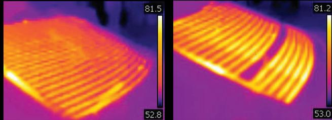
So erkennen Sie Leitungsunterbrechungen in der heizbaren Heckscheibe.
