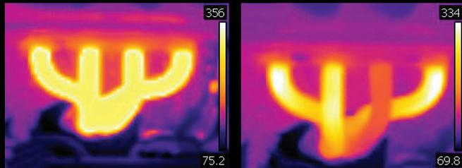
Mit sichtbarer Auspuffwärme erkennen Sie Fehlzündungen bei Zylindern.
